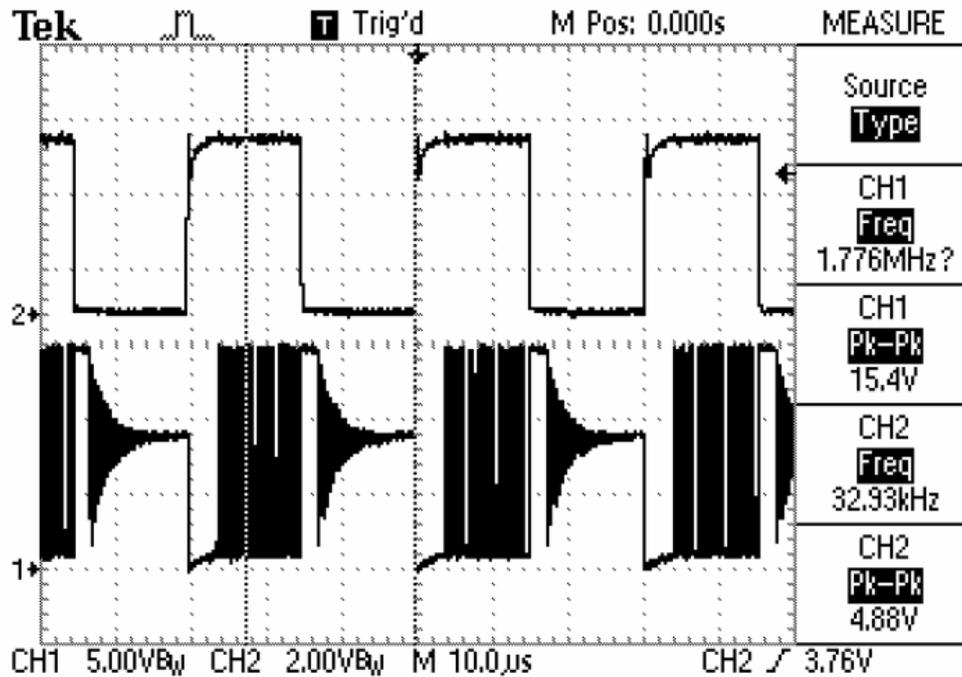
CH1: DIM pin PWM 輸入波形(duty 為 50%), CH2: LD pin 輸出波形
